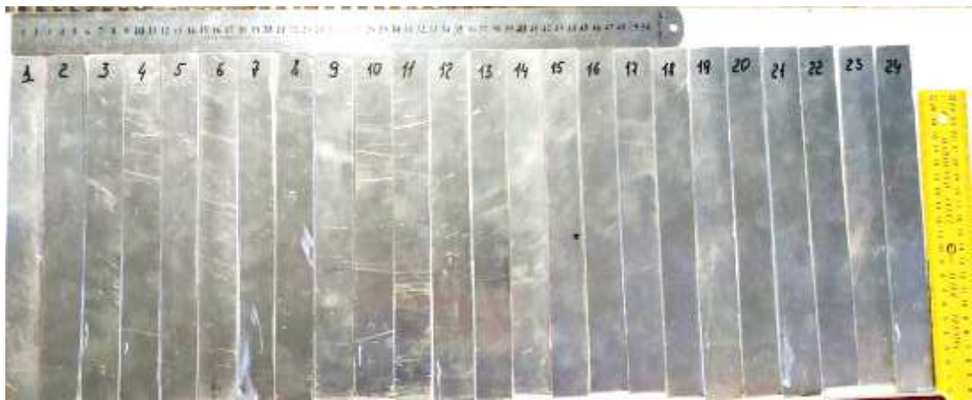
Рисунок 3.24 – Загальний вигляд зразків до прокатування з АМГ6 геометричними розмірами 1,9x30x240 мм
